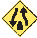
Carretera Dividida (Camino) Termina
